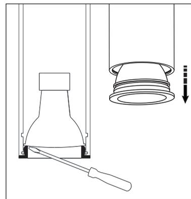
Para a troca de lâmpadas basta retirar o ANEL TRAVA. Caso haja dificuldade no desencaixe, utilize uma chave de fenda como indicado na figura acima.
